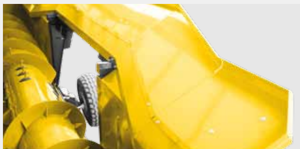
SPRITZBLECH Zum Vermeiden von Spritzverlusten über die Schneidwerksrückwand
