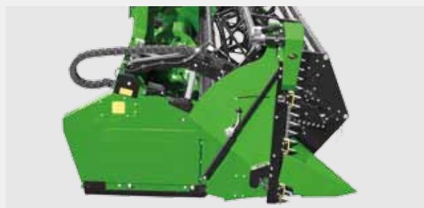
INTEGRIERTE ELEKTRISCHE ODER HYDRAULISCHE RAPSTRENNER Einsatz auch in Kombination mit dem Halmteiler möglich (z.B.: Roggen)
