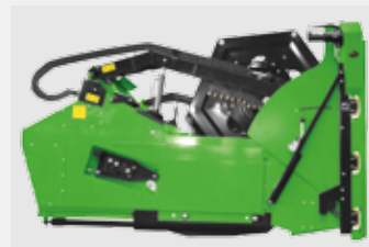
MÄHMESSER VOLL AUSGEFAHREN und Rapstrenner hochgeklappt
