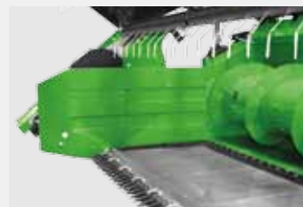
MÄHMESSER VOLL AUSGEFAHREN Abstand zu Einzugschnecke 1070 mm
