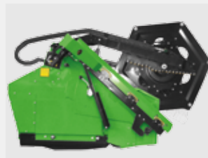
MÄHMESSER GANZ EINGEFAHREN und Rapstrenner eingeklappt
