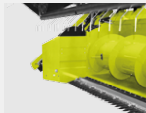
MÄHMESSER GANZ EINGEFAHREN Abstand zu Einzugschnecke 370 mm
