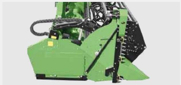
**SCIES À COLZA INTÉGRÉES AVEC CONTRÔLE ÉLECTRIQUE OU HYDRAULIQUE**
