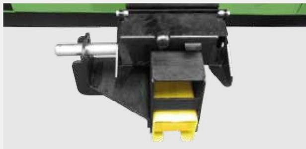
**SYSTÈME D'ANCRAGE FACILE AU CHARIOT DE TRANSPORT DE BARRES**
