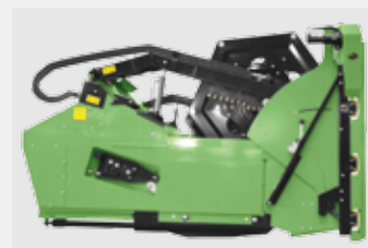
MÄHMESSER VOLL AUSGEFAHREN und Rapstrenner hochgeklappt
