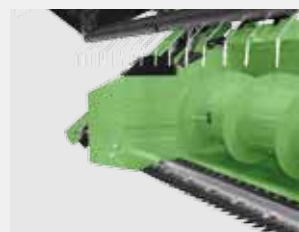
MÄHMESSER GANZ EINGEFAHREN Abstand zu Einzugschnecke 370 mm
