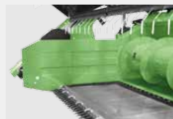
MÄHMESSER VOLL AUSGEFAHREN Abstand zu Einzugschnecke 1070 mm
