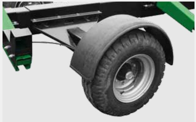
**40 KM/H AUSFÜHRUNG (KOTFLÜGEL, ALLRADBREMSE USW.)**
