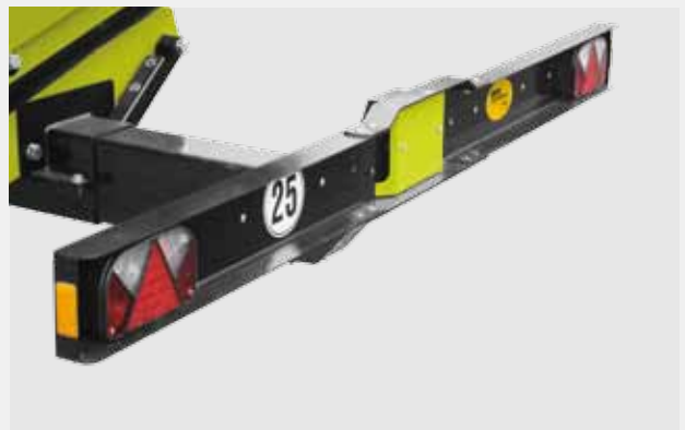
HÖHERGESTELLTER LICHTBALKEN Zum Vermeiden von Schäden bei steilen Feldeinfahrten
