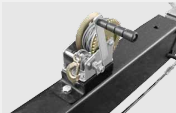
SEILWINDE BEI SWIFT UND TANDEM Zum Heranziehen des Wagens beim Anhängen
